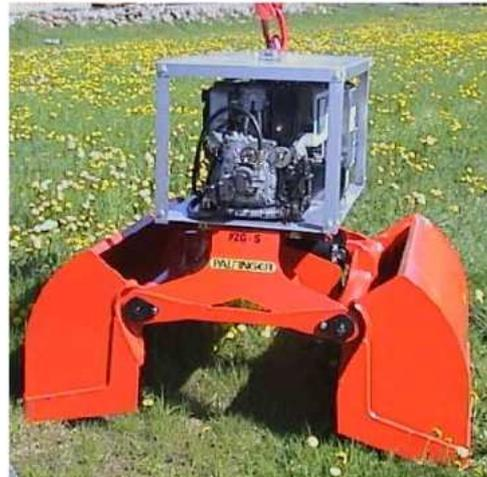
Einsetzbar mit jedem Kran, da ein eigenes Motor-, Hydraulikaggregat aufgebaut ist. Daher besonders geeignet für Dachbekiesungen und Hinterfüllungen.
